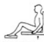
te hoge voelsteunen - de doekvlakken raken de zitting niet, waardoor gewicht op kleine oppervlakte (drukverhoging)
